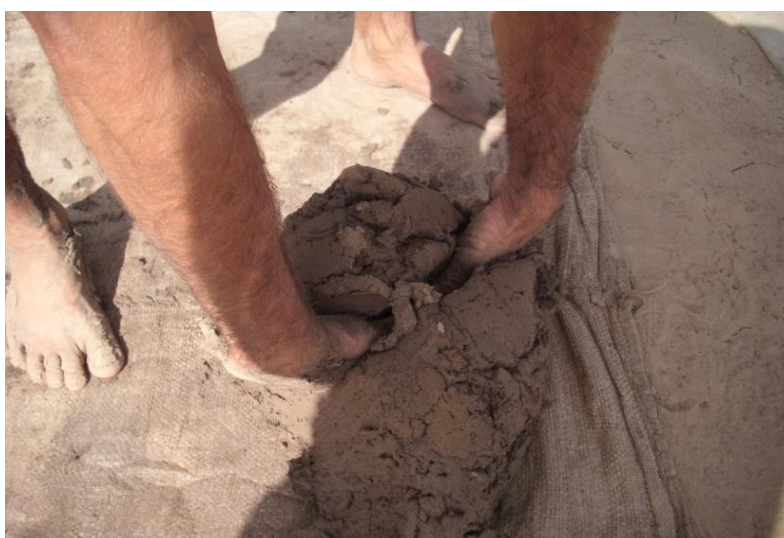
Figura 2: Oleiro utilizando os dedos polegares para cortar o barro e pegar, com as mãos, o “bolão” que vai utilizar. Fonte: Francisco Mendes. Arquivo pessoal, 2010.
