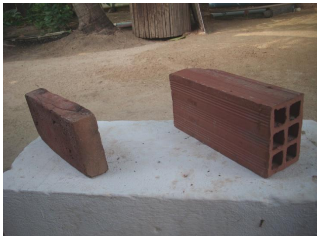
Figura 10: A esquerda tijolo corrido produzido pelos oleiros. A direita tijolo com furos produzido nas fábricas. Fonte: Francisco de Assis Mendes. Arquivo pessoal, 2011.
