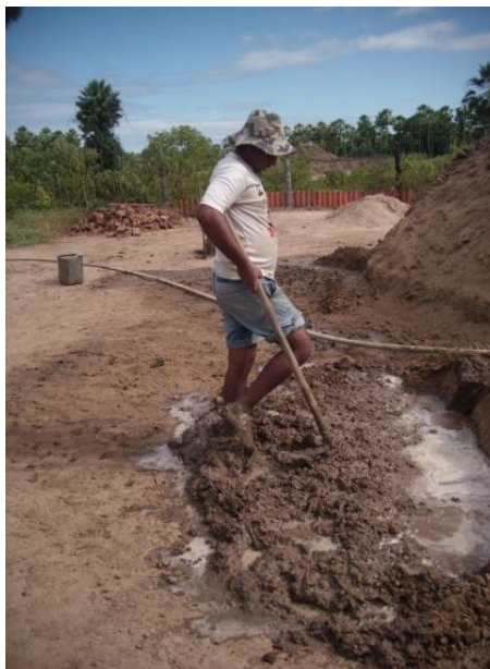
Figura 4: Oleiro utilizando os pés para amassar o barro. Fonte: Francisco Mendes. Arquivo pessoal, 2010.
