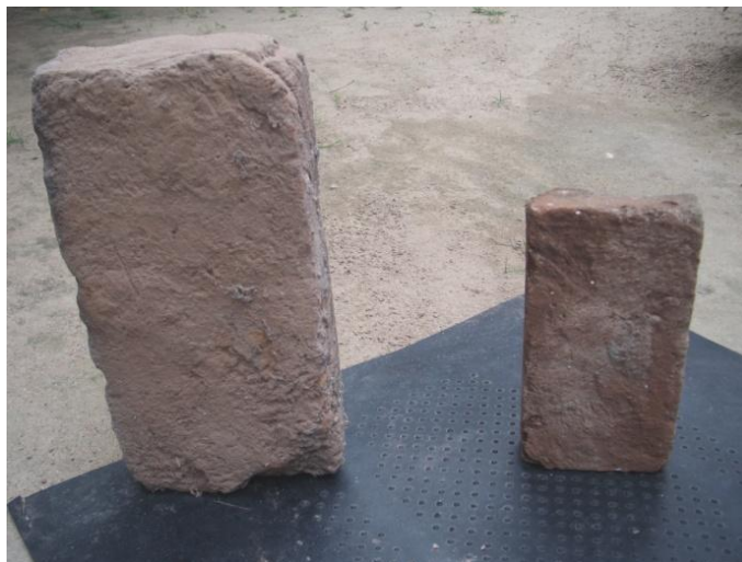
Figura 1: Tijolos tradicionais ou tijolo corrido . O de tamanho maior é o mais antigo. O da direita, com tamanho menor é de fabricação recente. Fonte: Francisco Mendes. Arquivo pessoal, 2010.
