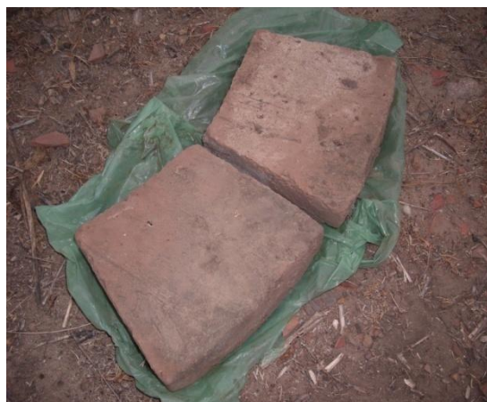
Figura 5: Tijolo tipo cunha usado em estruturas arredondadas como os antigos cacimbões e nas chaminés das fábricas de cerâmica. Fonte: Francisco Mendes. Arquivo pessoal, 2011.
