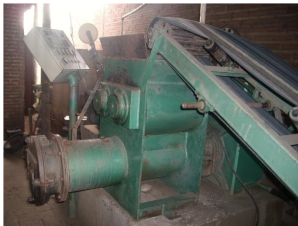
Figura 6: Máquina extrusora. Fonte: Francisco Mendes. Arquivo pessoal, 2011.
