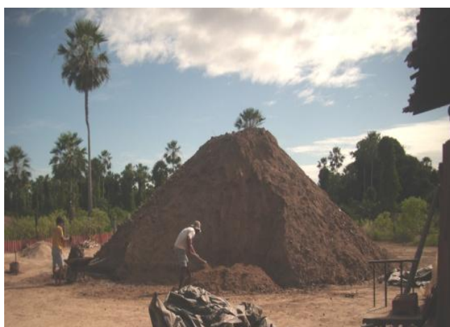
Figura 12: Oleiro preparando o barro na base do amontoado feito pela máquina. Fonte: Francisco Mendes. Arquivo pessoal, 2010.
