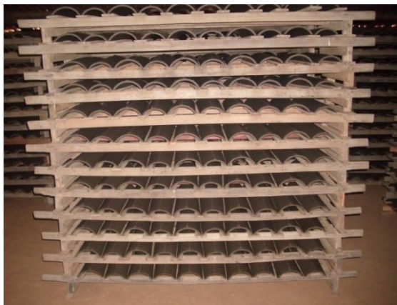
Figura 7: Lote de grades com telhas saídas da produção. Fonte: Francisco Mendes. Arquivo pessoal, 2011.
